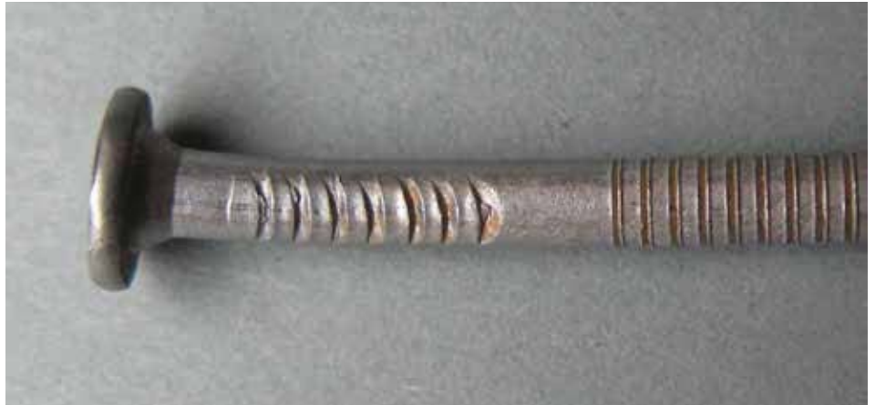
Abb. 5: Feuerverzinkter Rillennagel, 16 Jahre in Bauholz eingeschlagen
