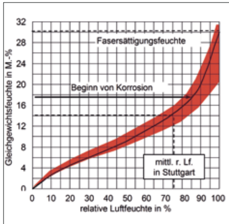
Abb. 4: Holzfeuchte in Abhängigkeit von der relativen Luftfeuchte (Sorptionisotherme für Fichtenholz bei 20 °C)
