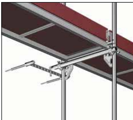
Abb. 7: Schematische Darstellung eines demonitierbaren „WDVS Ankers“ (Wilhelm Layher GmbH & Co. KG)
